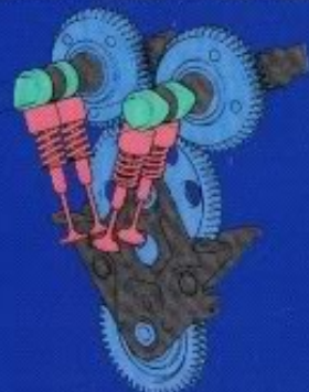
カムギアトレーンと直動式バルブ駆動の構造図
